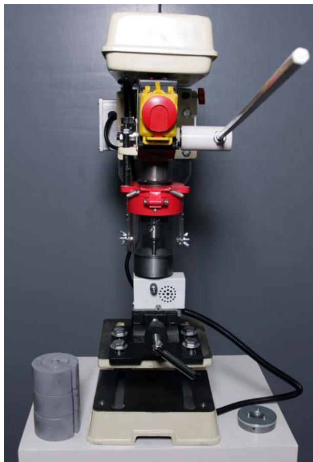
Рис. 2. Универсальный триботехнический комплекс
