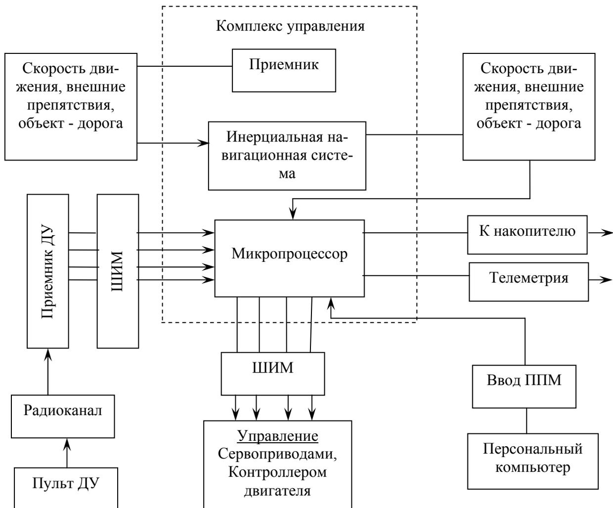
Рис. 1. Функциональная схема управления робототехническим комплексом
