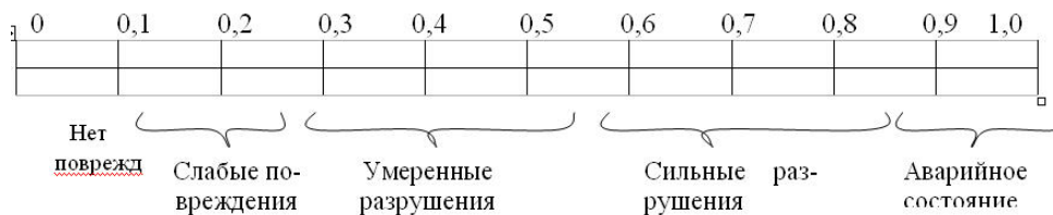
Рис. 4. Оценка состояния существующих зданий (сооружений) и их вербальное отображение
