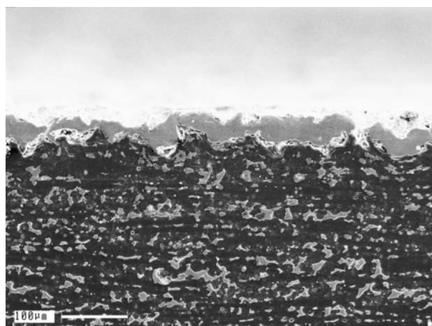
Рис. 8. Антифрикционный слой (снизу) и приработочное покрытие из баббита Б83 (сверху)
