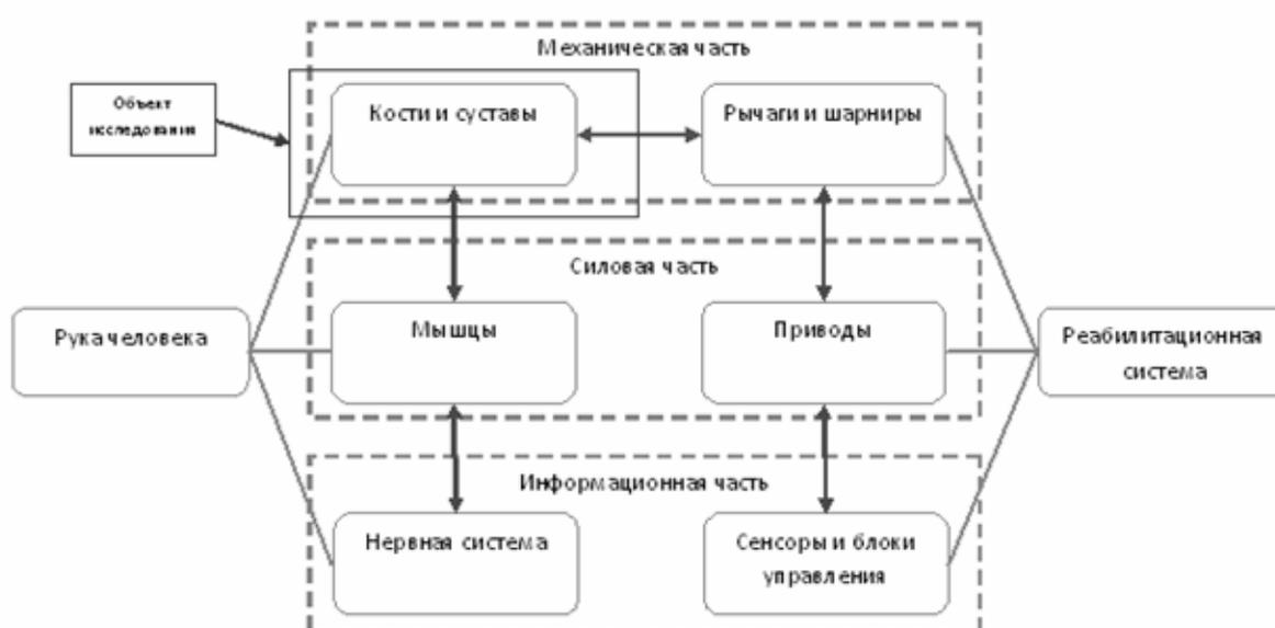
Рис. 2. Структурная схема системы рука-устройство
