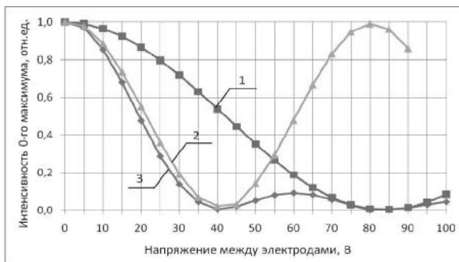
Рис. 5. Изменение интенсивности нулевого максимума различных УДОЭ: 1 – амплитудный УДОЭ; 2 – фазовый УДОЭ; 3 – амплитудно-фазовый УДОЭ
