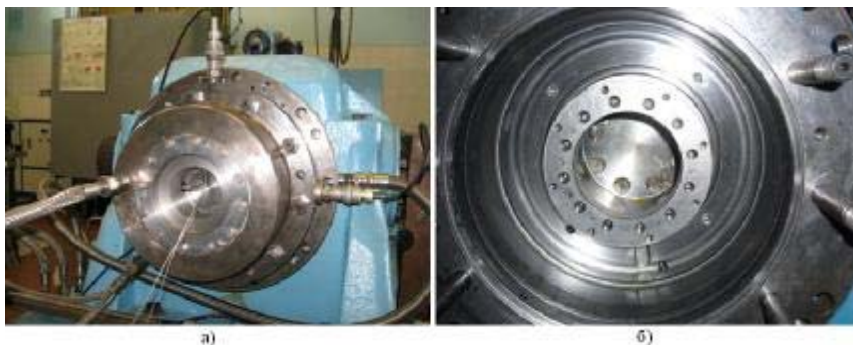
Рис. 1. Фотография испытательного стенда: а – с установленными датчиками перемещения корпуса и ротора; б – в разобранном виде после испытаний
