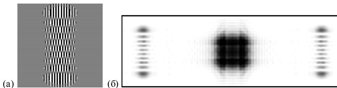
**Рис. 2.** Формирование мод ЭГ (0,9), распространяющихся под углами к оптической оси: а - фаза частично кодированного ДОЭ, б - распределение интенсивности (негатив), рассчитанное на расстоянии  $z=500$  мм от плоскости ДОЭ
