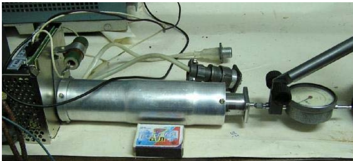
Рис. 2. Опытный образец силового привода из сплава с ЭПФ для узла расчеховки КА
