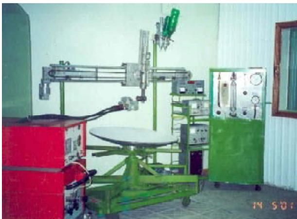
**Рис. 1.** Мобильная малогабаритная установка плазменного газотермического напыления
