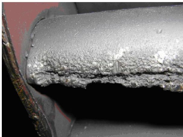
Рис. 6. Общий вид повреждений и эрозии лопаток 27 ступени, которые эксплуатировались без покрытия
