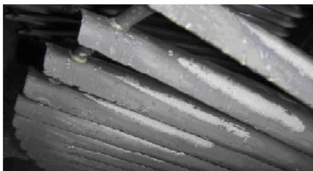
Рис. 4. Общий вид лопаток 29 ступени с покрытием после 62142 часов наработки
