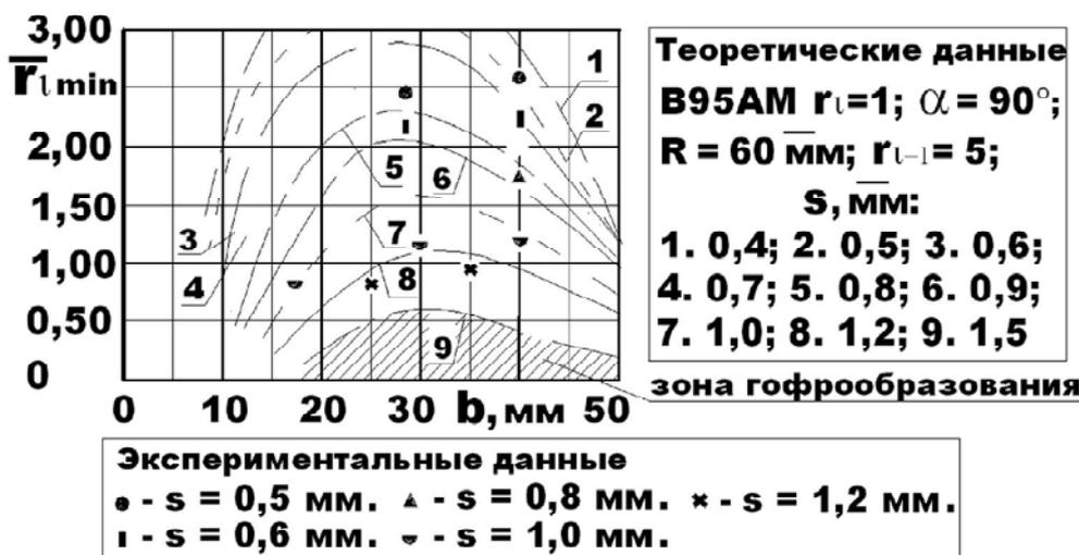
Рис. 13. Экспериментальная проверка адекватности теории по определению минимальных радиусов зон сгиба для профилей швеллерного сечения  $r_{i \min}$
