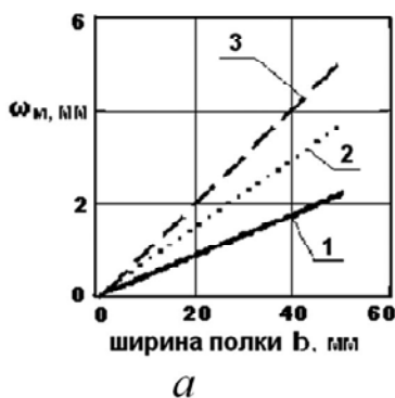
Рис. 3. Амплитуда кромковой волнистости: а – в зависимости от ширины подгибаемой плоской полки; б – в зависимости от угла подгибки за проход
