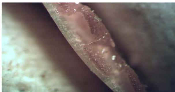
**Рис. 7.** Структура препрега с асимметричным наносом модифицированного связующего (увеличение  $\times 100$ )
