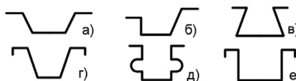
Рис. 9. Основные типы профилей корытного типа
