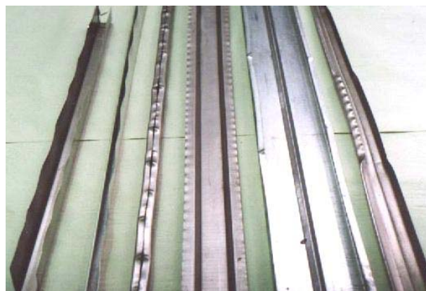
Рис. 15. Типичные формы гофрообразования краевых подгибаемых элементов тонкостенных профилей
