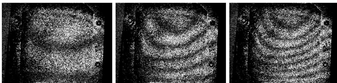
**Рис. 5.** Характерный вид температурной деформации пластины в прямоугольной рамке с равномерной жесткостью закрепления по краям
