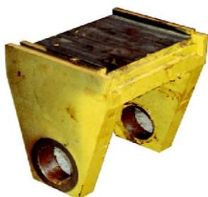
Рис. 5. Опорное устройство телескопической стрелы автомотрисы дизельной монтажной АДМ-1.5 после проведения эксплуатационных испытаний.
