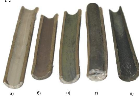
Рис. 3. Фото образцов, полученных для материаловедческого анализа: а) образец №1 «контрольный» образец, не участвовавший в эксперименте (исходное состояние); б) образец №2 образец после выдержки в среде атмосферного воздуха при Т=5500С в течение 100 часов; в) образец №3 образец, выдержанный в среде циркулирующего расплава свинца при Т=5500С в течение 100 часов; г) ответная к образцу № 3 поверхность застывшего свинца; д) образец №5 образец циркуляционного контура стенда после дренирования теплоносителя.
