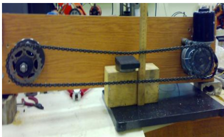
Рис. 3. Демонстрация установки бесконтактного натяжения цепи с помощью магнита.
