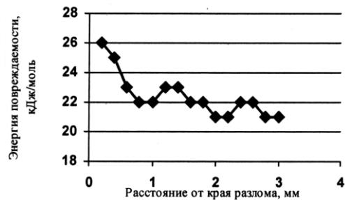
Рис. 11. Характерные результаты оценки величины энергии повреждаемости материала при усталостных испытаниях, начиная от края разлома образца.
