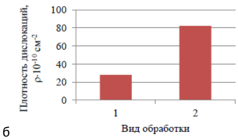
Рис.7. Зависимость энергии деформации U_{\text{деф}} (а), плотности дислокаций \rho (б), размеров блоков мозаик D (в), микроискажений \Delta a/a (г), от видов обработки сплава Вт9: 1 – притирка по шлифованию, 2-притирка по точению, 3 – шлифование, глубина склерометрирования h \approx 3 мкм.
