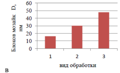
Рис.6. Зависимость энергии деформации U_{\text{деф}} (а), плотности дислокаций \rho (б), размеров блоков мозаик D (в), микроискажений \Delta a/a (г), от видов обработки стали 40X: 1 - притирка, 2 - шлифование, 3 – точение, глубина склерометрирования h \approx 3 мкм.
