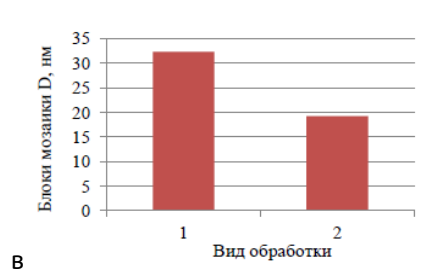
Рис.7. Зависимость энергии деформации U_{\text{деф}} (а), плотности дислокаций \rho (б), размеров блоков мозаик D (в), микроискажений \Delta a/a (г), от видов обработки сплава Вт9: 1 – притирка по шлифованию, 2-притирка по точению, 3 – шлифование, глубина склерометрирования h \approx 3 мкм.
