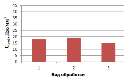
Рис.2. Повреждаемость поверхностей U_{деф} стали 40Х при различных видах обработки: 1 - притирка; 2-шлифование тонкое; 3-точение.
