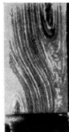
Рис. 2. Тепловая конвекция в трубке круглого сечения [4]
