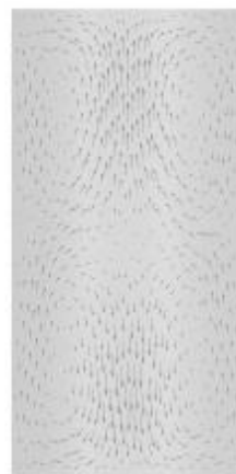
Рис. 8. Поле вектора скорости в продольном сечении цилиндра
