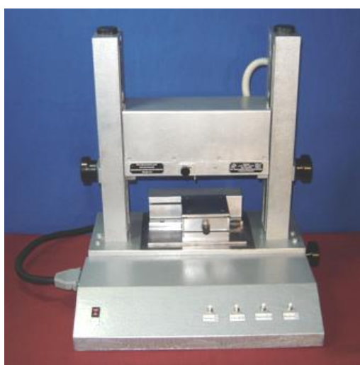
Рис. 3. Диагностический программно-аппаратурный комплекс для оценки качества поверхностей.
