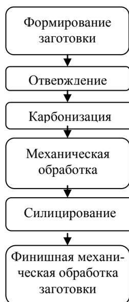
**Рис.1.** Принципиальная технологическая схема изготовления тормозных керамических дисков из материала типа C/C-SiC.
