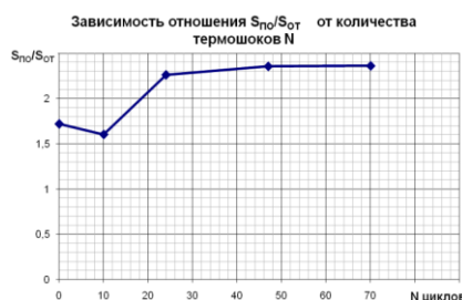
Рис. 5. Зависимость отношения S_{по}/S_{от} от числа термоциклов для МДО-покрытия сплава АК9.
