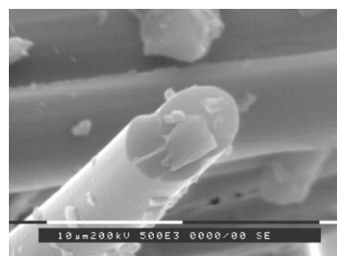
Рис. 2. Область разрушения по границе волокон, расположенных в долевом и поперечном направлении (а); структура излома углеродного волокна (б).
