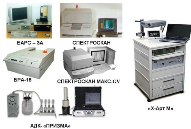
Рис.1. Перспективные отечественные рентгеноспектральные анализаторы.
