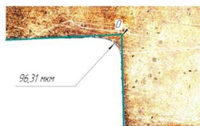
Рис. 8. Погрешность обработки: а) скорректированная технология обработки; б) первоначальная технология обработки
