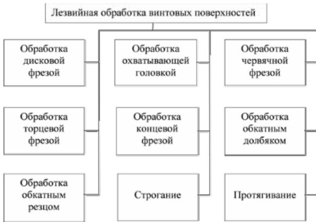
Рис. 1. Способы лезвийной обработки винтовых поверхностей
