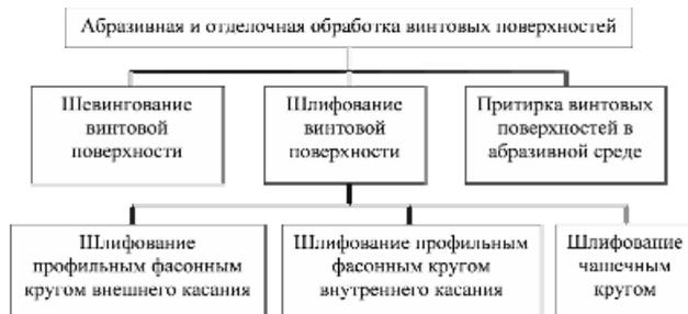
Рис. 2. Способы абразивной и отделочной обработки винтовых поверхностей
