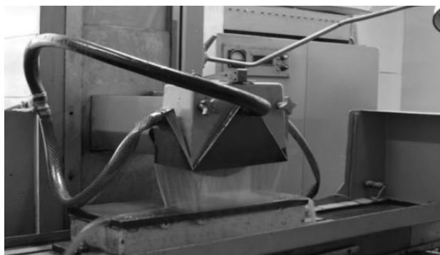
Рис. 4. Общий вид установки для подачи СОЖ
