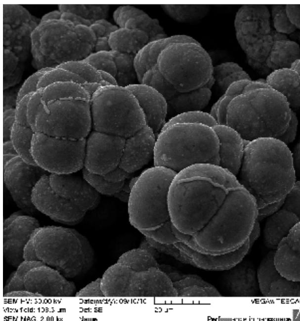
Рис. 3. Изображение поверхности образца электроосажденной латуни, полученное с помощью аналитического растрового электронного микроскопа VEGA\ SB, Tescan, увелич. x2000.
