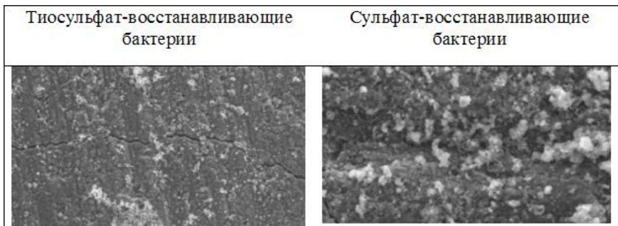
Рис. 4. Колонизация поверхности цементных строительных образцов. Ув. 100 x
