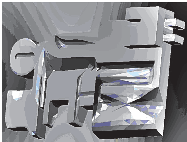
Рис. 7. Низкополигональная трёхмерная модель поверхности пряничной доски, полученная с применением программных средств Solid Works в формате .stl
