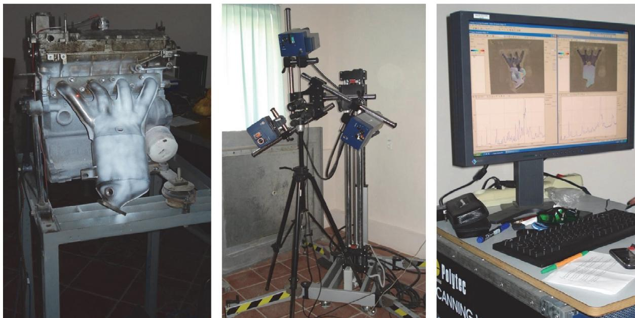
Рис. 6. Внешний вид «холодной» безмоторной установки и лазерного вибросканирующего измерителя
