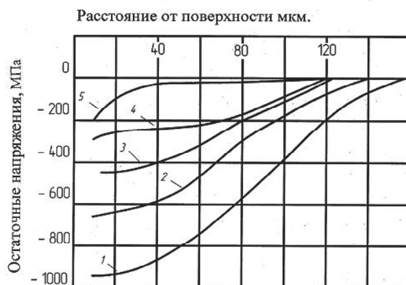
Рис. 5. Изменение остаточных напряжений в поверхностном слое образцов из сплава ЖС6ФН после обработки микрошариками в зависимости от времени выдержки при T = 800\text{ }^{\circ}\text{C} : 1 - 2 ч; 2 - 8 ч; 3 - 25 ч; 4-50 ч; 5-100 ч
