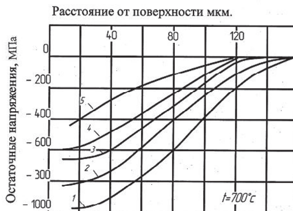
Рис. 4. Изменение остаточных напряжений в поверхностном слое образцов из сплава ЖС6ФН после обработки микрошариками в зависимости от времени выдержки: 1- 2 ч; 2 – 8 ч; 3 – 25 ч; 4 – 50 ч; 5 – 100 ч
