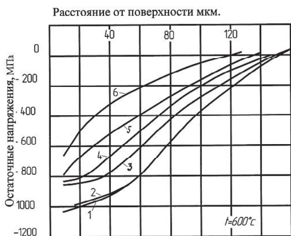
Рис. 3. Изменение остаточных напряжений в поверхностном слое образцов из сплава ЖС6ФН после обработки микрошариками в зависимости от времени выдержки при T = 600\text{ }^{\circ}\text{C} : 1 – до нагрева; 2 – 2 ч; 3 – 8 ч; 4 – 25 ч; 5 – 50 ч; 6 – 100 ч
