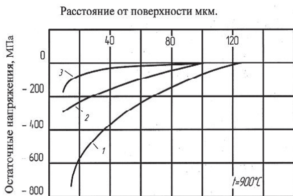
Рис. 6. Изменение остаточных напряжений в поверхностном слое образцов из сплава ЖС6ФН после обработки микрошариками в зависимости от времени выдержки при T = 900^\circ\text{C} : 1 - 2 ч; 2 - 8 ч; 3 - 25 ч
