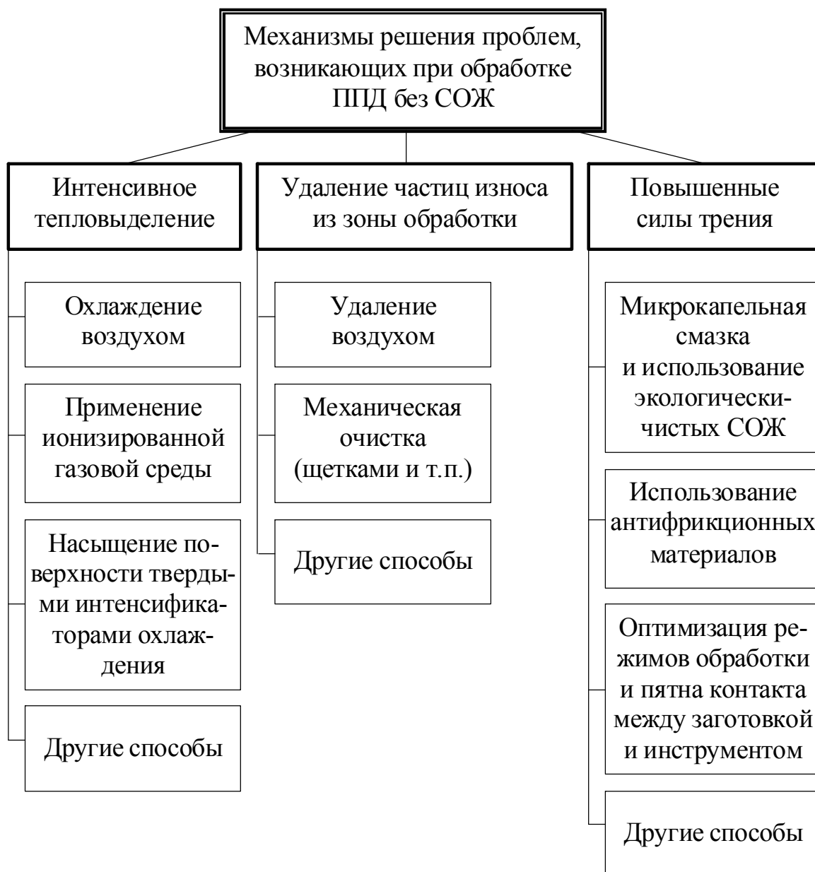
Рис. 2. Механизмы решения проблем, возникающих при обработке ППД без использования СОЖ
