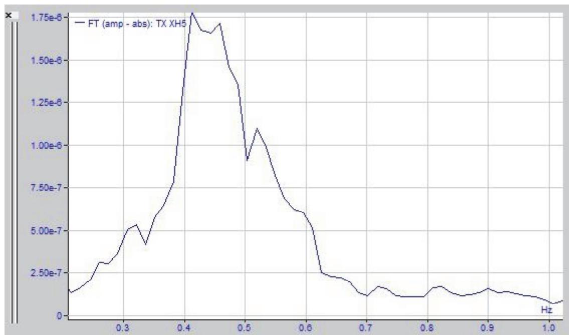
**Рис. 4.** Анализ Фурье для полосы после холодной прокатки
