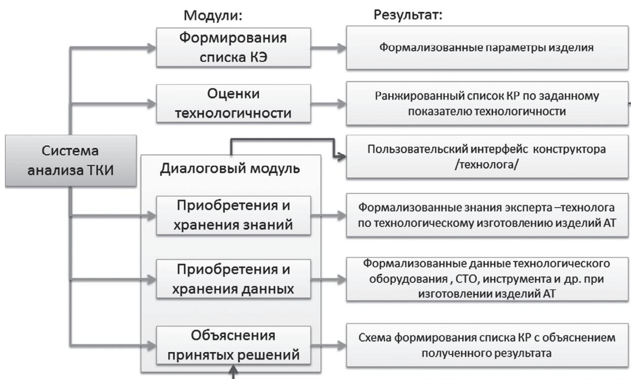
Рис. 1. Концепция проектирования изделий АТ с обеспечением технологичности изделия
