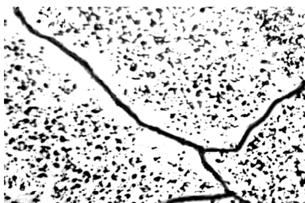
Рис. 2. Авторадиограмма-реплика стали после проникновения атомов ^{63}\text{Ni} под действием одного акта электрогидроимпульсной обработки, \times 4800
