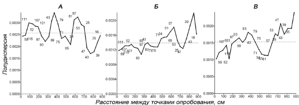
Рис. 3. Экспериментальные семивариограммы МВ, построенные для линий опробования в пределах постоянных глубин разреза 2-2010 (пунктирная линия – величина дисперсии, цифры у точек указывают количество пар, используемых в анализе): А – линия опробования вдоль горизонта А1старопах (глубина 10 см), Б – вдоль горизонта А1А2 (30 см), В – вдоль горизонта А1А2В (50 см)
