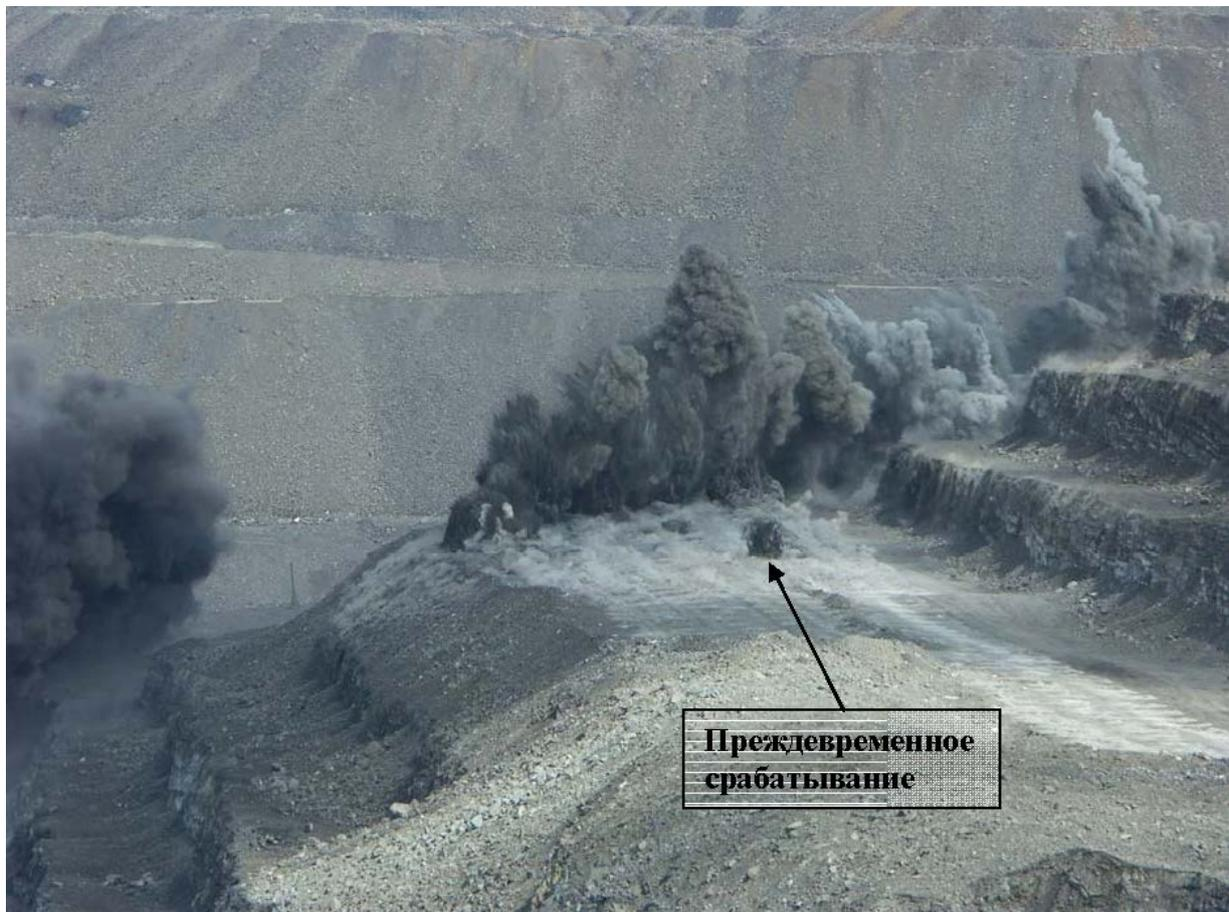
**Рис. 9.** Взрыв блока с использованием системы СИНВ
