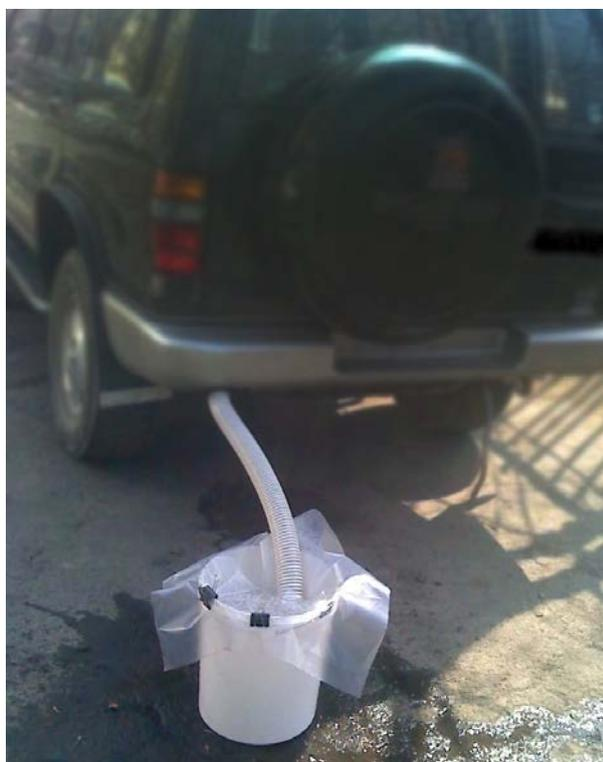
**Рис. 1.** Устройство для замеров взвесей выхлопа автомобиля, состоящее из пластикового ведра, шланга и целлофана с зажимами для фиксации
