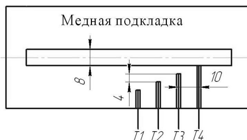
Рис. 4. Схема установки термопар в медную подкладку
