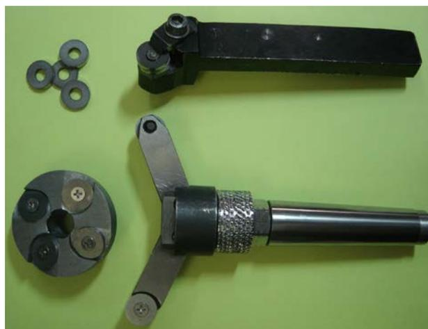
**Рис. 3.** Образцы инструмента с СРП нового типа
