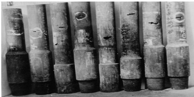
Рис. 1. Разрушение бурильных труб в зоне концентрации напряжений
