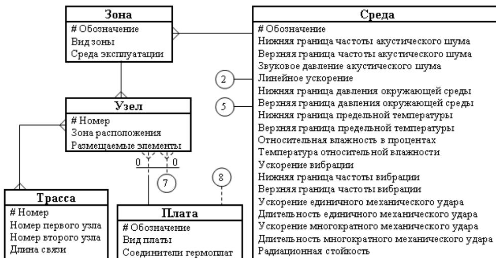
Рис. 3. Фрагмент информационной модели, описывающий конструктивные объекты изделия
