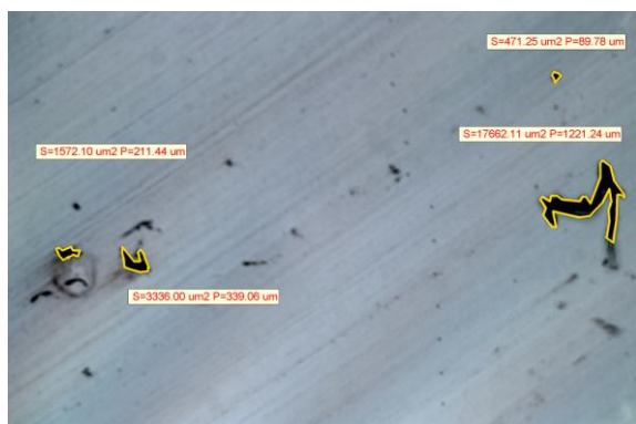
Рис. 3. Поры в наплавке (нетравленный образец) (x500)
