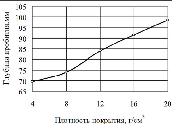
**Рис. 4.** Влияние плотности покрытия КО на глубину пробития КЗ при толщине медной заготовки 0,5 мм и толщине слоя покрытия 0,3 мм
