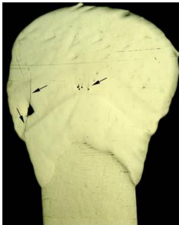
Рис. 5. Вид наплавки торца пера на лопатке №1 (шлиф нетравленный). Стрелками указаны трещины, несплавления и рыхлоты
