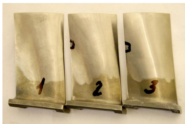
Рис. 3. Внешний вид лопаток после механической обработки
