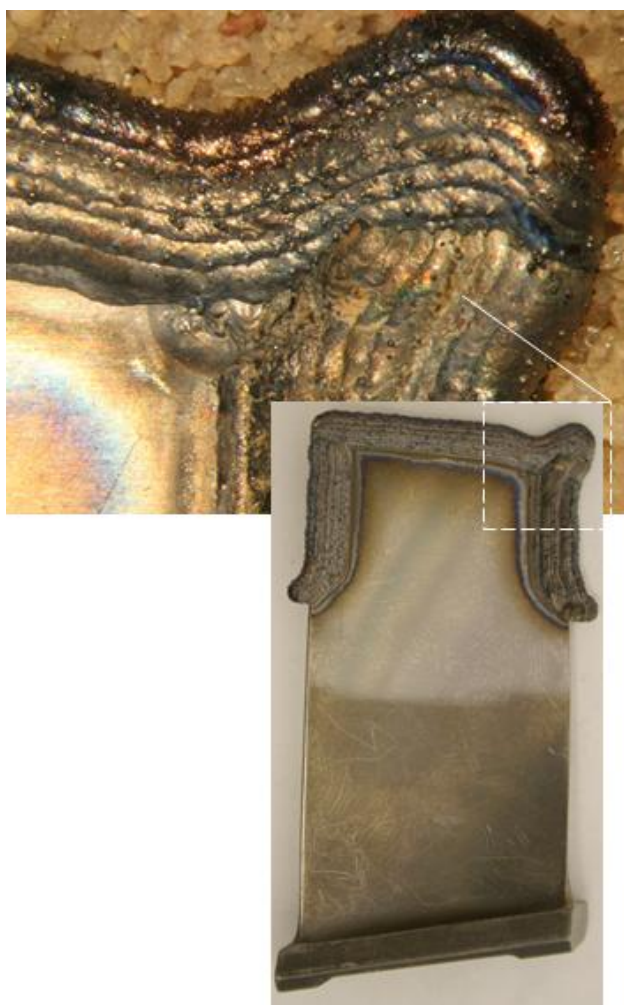
Рис. 2. Вид лопатки №2 после наплавки торца и кромок
