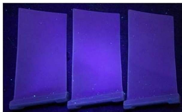
Рис. 4. Вид индикаций при люминесцентной дефектоскопии
