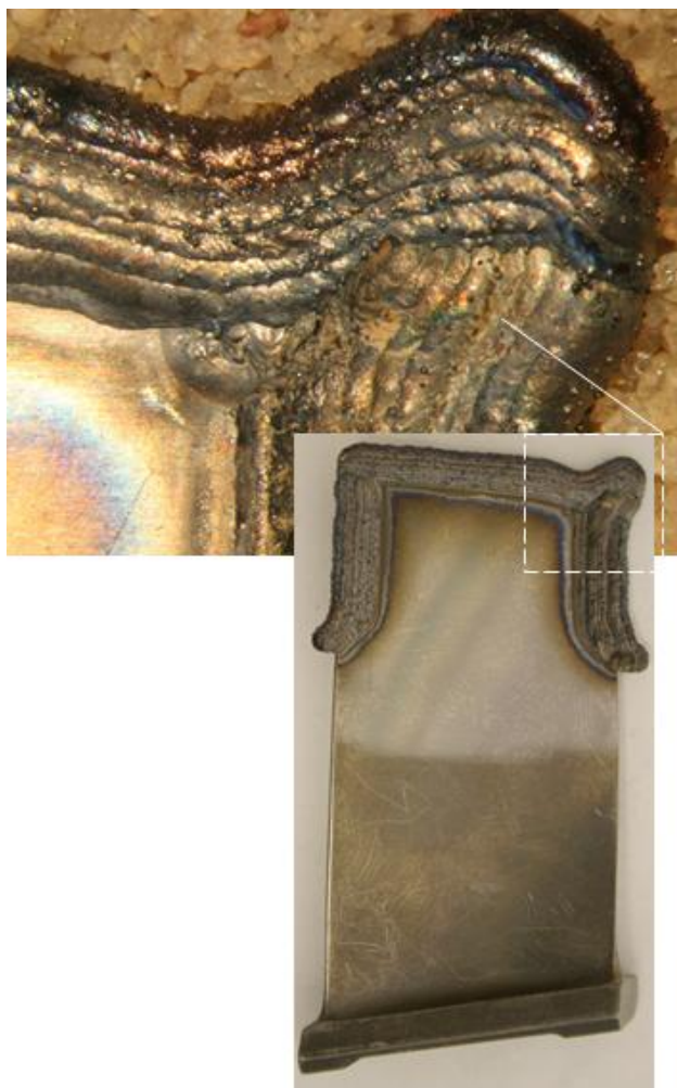
Рис. 2. Вид лопатки №2 после наплавки торца и кромок
