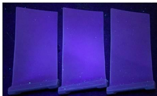
Рис. 4. Вид индикаций при люминесцентной дефектоскопии
